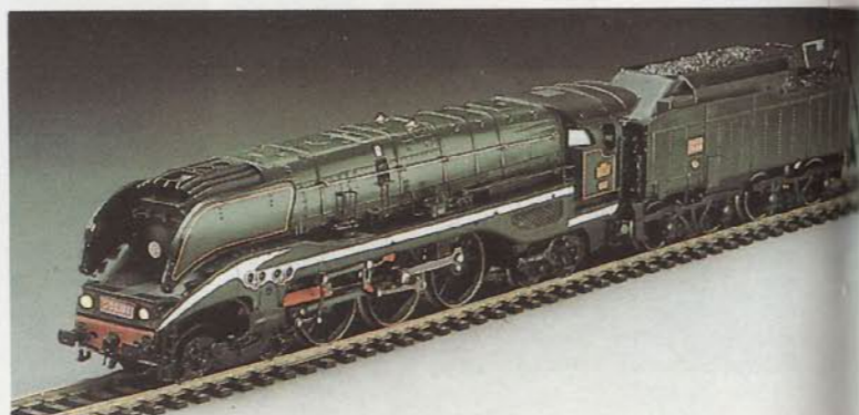
8249 - 232 U 1. Tender 36 B 6. Longueur totale : 287 mm. Éclairage avant et arrière. Mise en service : 1949. Radiée en 1961. Région d'affectation : Nord. Services assurés : express et rapides. Vitesse maxi en service : 120 km/h. Appelée par les cheminots "LA DIVINE". Visible au Musée de Mulhouse.
