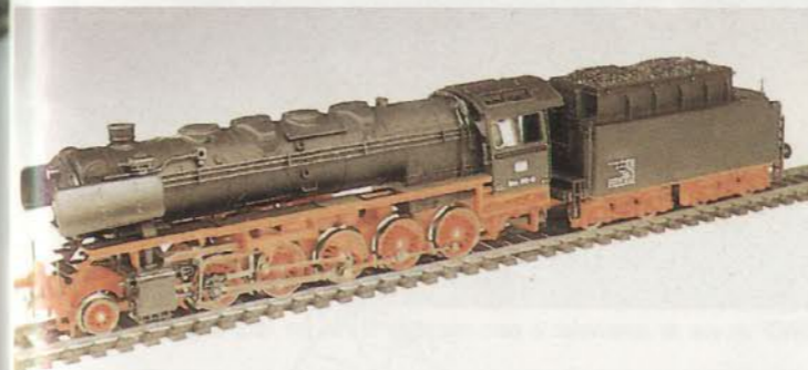
8269 - 141 P. Tender 36 P. Longueur totale : 280 mm. Mise en service : 1942 à 1952. Radiée en 1969. Régions d'affectation : Est, Ouest, Sud-Est. Service assuré : mixte. Vitesse maxi en service : 105 km/h.
