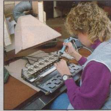
Soudage circuits imprimés de transformateurs.
