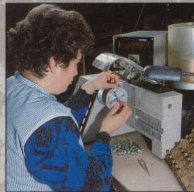
Bobinage des rotors de moteurs JOUEF.
