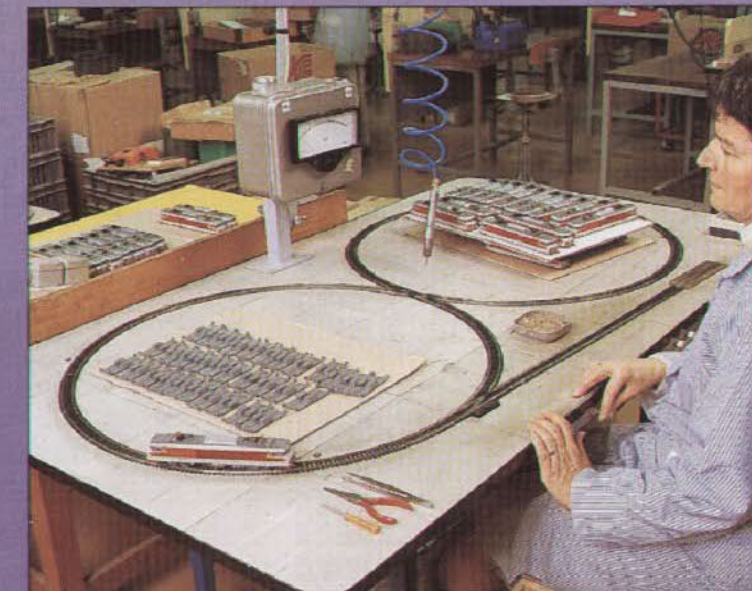
Vérification du fonctionnement avant assemblage définitif
