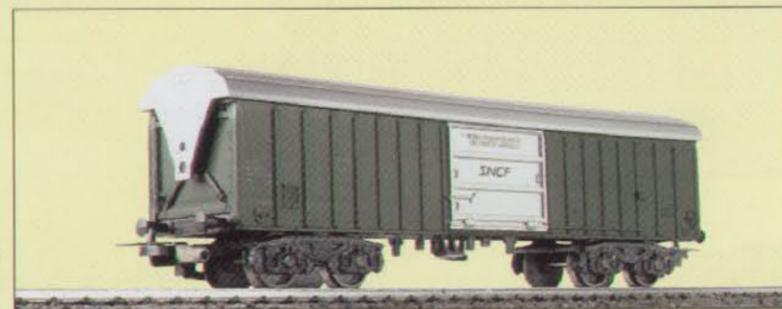
330400 - Wagon fermé de la S.N.C.F. type "TS", avec toit ouvrant.
