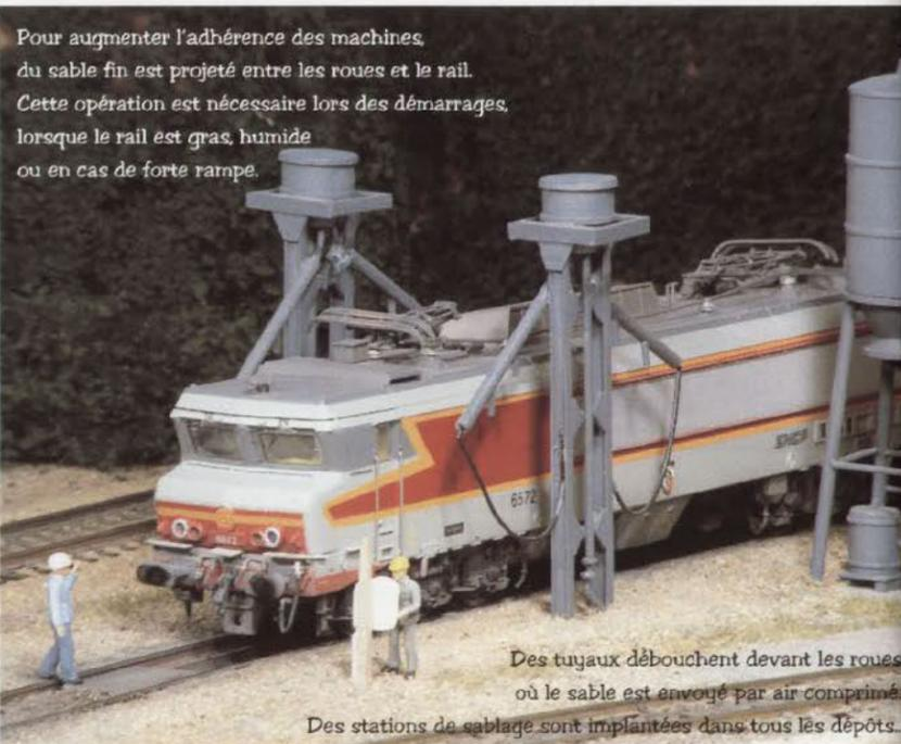
Des tuyaux débouchent devant les roues où le sable est envoyé par air comprimé. Des stations de sablage sont implantées dans tous les dépôts.
