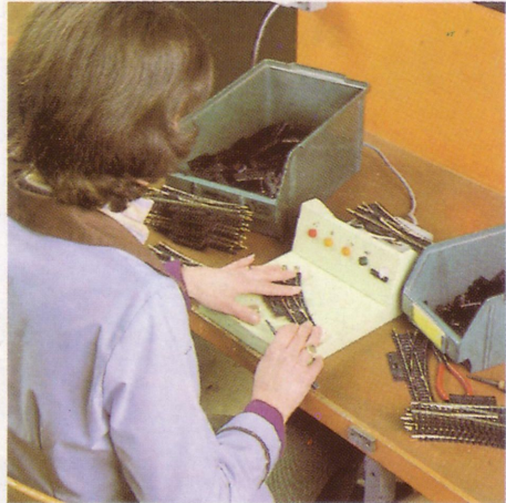
CONTROLE ÉLECTRIQUE DES AIGILLAGES
