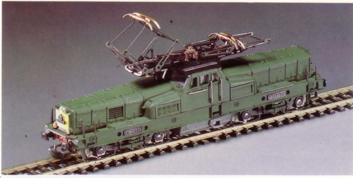
8334 - BB 12079. Série de 12001 à 12148. 295,60 Longueur : 173 mm. Eclairage inversé. Mise en service : 1954 à 1961. Régions d'affectation : Est - Nord. Service assuré : mixte. Vitesse en service 120 km/h. Locomotive appelée : VALENCIENNES-THIONVILLE
