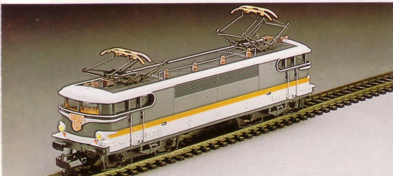
8329 - BB 9281. Série de 9201 à 9292 285,50 Longueur : 185 mm. Eclairage inversé. Mise en service : 1957 à 1963. Région d'affectation : Sud-Ouest. Service assuré : express « Corail » sur Paris-Orléans et Tours-Poitiers, avec réversibilité. Vitesse maxi : 160 km/h. La décoration « Corail » n'a été appliquée qu'en 1978.
