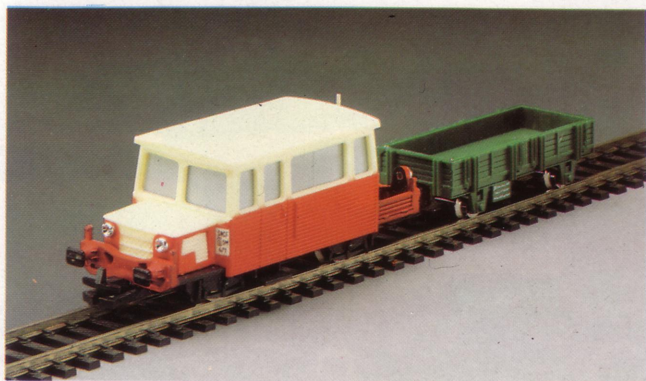
8525 - Draisine DU 65 157,50 Longueur totale 170 mm compris allège. Mise en service : 1967 à 1969. Régions d'affectation : toutes. Service assuré : Trains de service (inspection, entretien des voies). Vitesse maxi en service : 78 km/h.
