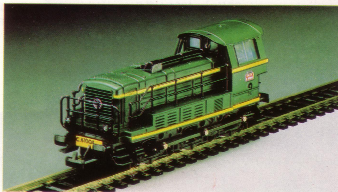
8503 - C 61004. Série de 61001 à 61048. 215,60 Longueur 109 mm. Eclairage. Mise en service : 1950 à 1953. Radiée en 1985. Régions d'affectation : Nord - Est - Ouest. Services assurés : manœuvres et dessertes marchandises locales. Vitesse maxi en service : 60 km/h.
