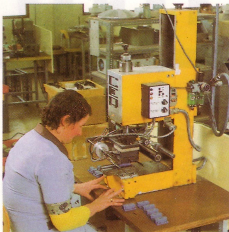
OPÉRATION DE DÉCORATION A CHAUD
