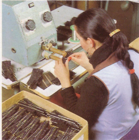
OPÉRATION DE SOUDURE ÉLECTRIQUE PAR POINTS
