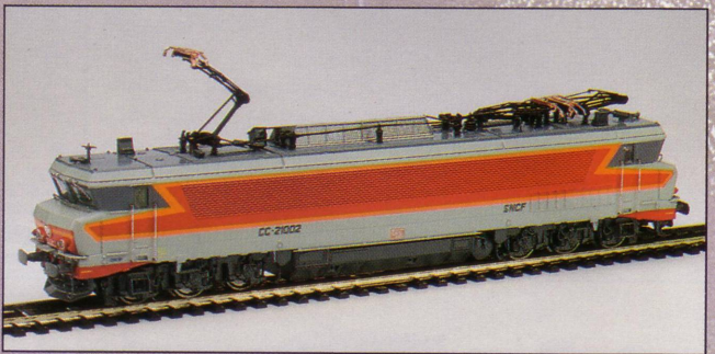
8441 - CC 21000 Longueur : 224 mm. Chassis Zamac. Moteur Bulher. Transmission par cardans. Prise de courant sur toutes les roues. Long. 19,5m. Poids 123 T.
