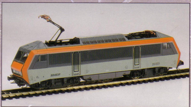
8370 - BB 26023 Longueur : 203 mm. Chassis Zamac. Moteur Bulher. Transmission par cardans. Prise de courant sur toutes les roues. Les BB 26000 dites "SYBIC" (Synchrone Bicourant), locomotives
