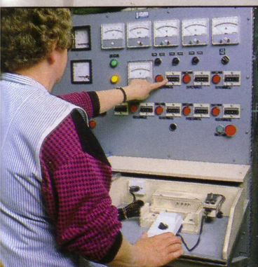
Banc d'essais de transformateurs.
