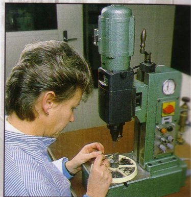
Montage d'un embellage.
