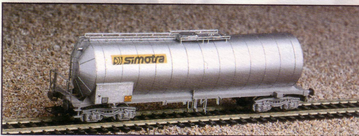
6516 - Wagon-citerne calorifugé 70 m 3 "Simotra" destiné au transport de produits chimiques. Longueur : 170 mm.
