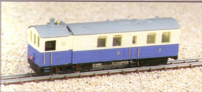
8150 - Automotrice vapeur échelle HOe. Reproduction du wagon tracteur de la ligne à voie étroite Ruhr-Lippe, compartiment de voyageurs articulé avec la partie tractrice.
