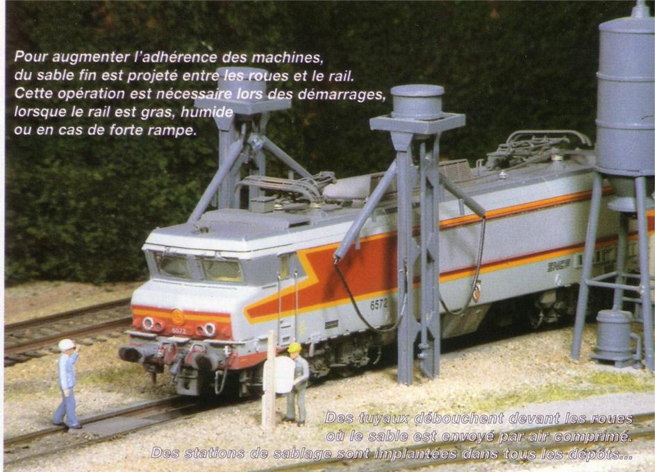
Des tuyaux débouchent devant les roues où le sable est envoyé par air comprimé. Des stations de sablage sont implantées dans tous les dépôts...
